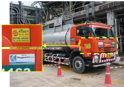
ภาพที่ 2.1-14 รถขนส่งกากของเสีย และขนส่งสารเคมีที่มีระบบ GPS และติดหมายเลขโทรศัพท์
