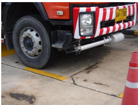
ภาพที่ 2.1-15 การติดตั้งอุปกรณ์ป้องกันไม่ให้เกิดประกายไฟ
