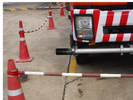
ภาพที่ 2.1-15 การติดตั้งอุปกรณ์ป้องกันไม่ให้เกิดประกายไฟ
