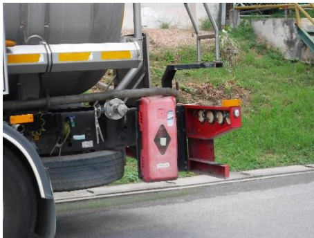
ภาพที่ 2.1-19 อุปกรณ์ความปลอดภัยต่าง ๆ สำหรับรถขนส่ง ได้แก่ ถังสารเคมีดับเพลิง, SDS และ PPE ประจำรถขนส่ง เป็นต้น
